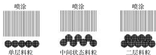
图4 饲料流的厚度对喷涂效果的影响
